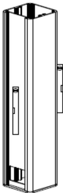
8- Une fois le battant posé et réglé, réinstallez la tôle décor en la glissant par le haut, encollez l'intérieur des embouts avec du mastic en cartouche et posez les sur les extrémités des poteaux.
